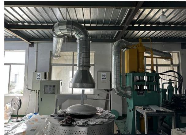
压铸和电熔炉
