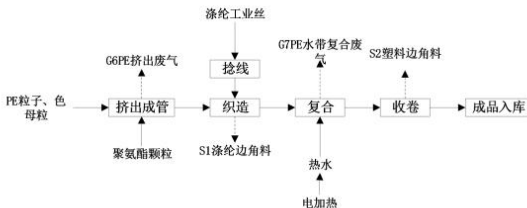
图 2-4 PE 水带生产工艺
