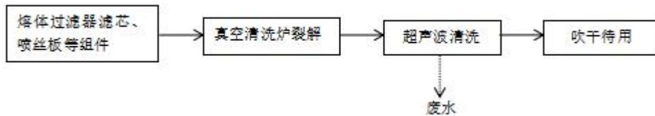
图 2-5 喷丝板碳化、清洗工艺流程及产污环节图
