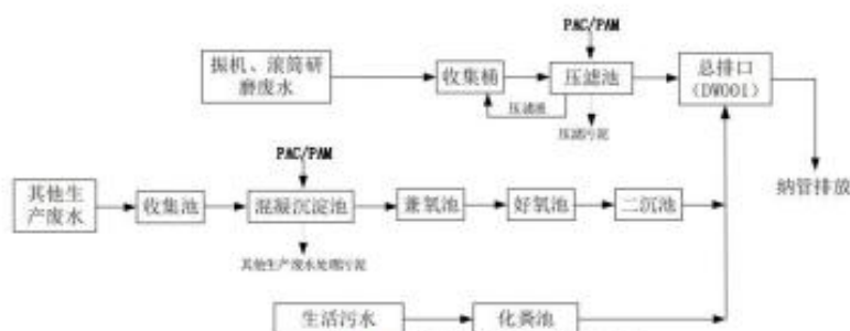
图 4-2 废水处理设施工艺流程图
